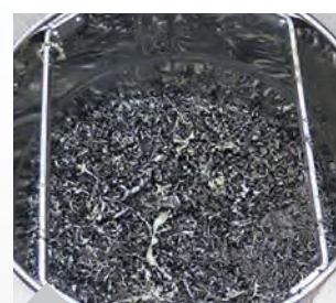
Depósito em aço inoxidável é resistente às aparas de metal afiadas
